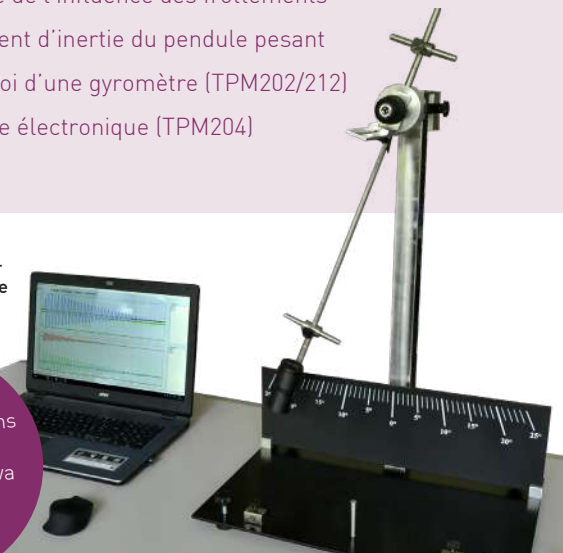
Pendule pesant supérieur avec acquisition numérique par la centrale inertielle bluetooth DynNova. Ref. TPM212
