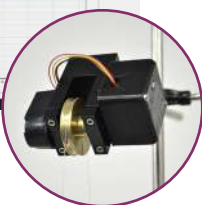
Pendule oscillant avec acquisition numérique par la poulie électronique 500pts/tour. Ref. TPM204
