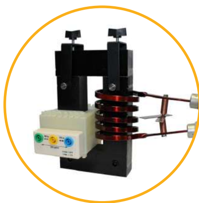
RÉALISATION D'UN MONTAGE DE TRANSFORMATEUR ET EXPÉRIENCE DE FUSION
