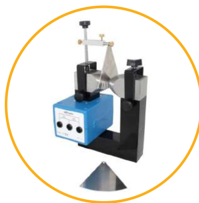
RÉALISATION D'UN PENDULE À INDUCTION DE WALTENHOFEN
