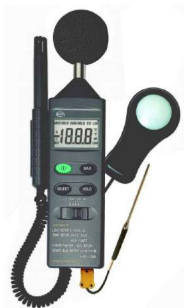
CAPTEUR COUTEAU SUISSE, 5 EN 1 : Mesure de la température ambiante Mesure par un thermocouple type K Mesure de l'humidité Mesure d'éclairement en lux Mesure de l'intensité sonore en db
